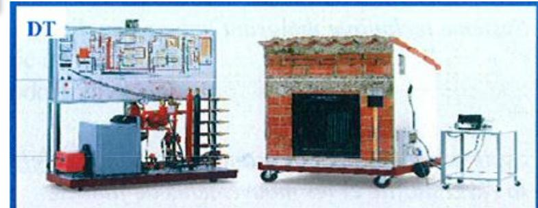
*Maquette pour l'étude et la mesure des déperditions thermiques dans les bâtiments. Murs de différents matériaux, différents isolants, porte fenêtre, chauffage et mesure / acquisition*
